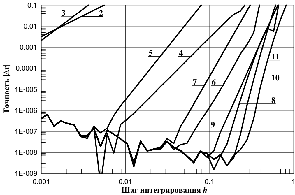
Рисунок 7.3 — Зависимость точности от величины шага интегрирования
